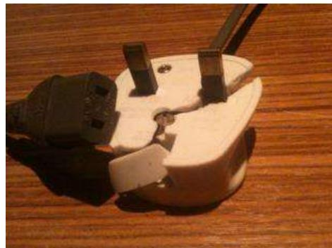
Utikač je slomljen zbog nemarnog postupanja. Radnik to mora prijaviti nadređenom kako bi pozvao električara koji će zamijeniti i ponovo povezati utikač.
