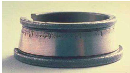
Slika 46 - Neusklađenost ležaja je dovela do prekomjernog habanja s jedne strane
