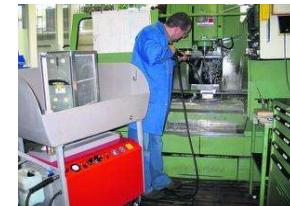
Slika 18 - Uređaj za pranje pod pritiskom
