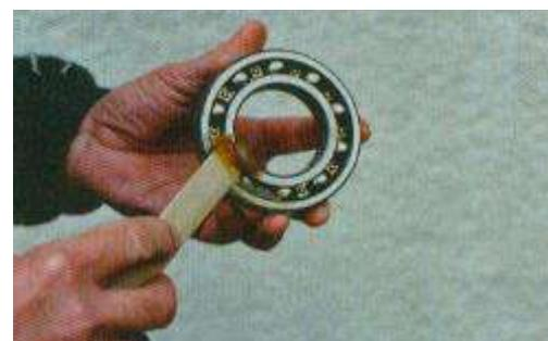
Slika 52 - Ručno podmazivanje kugličastog ležaja
