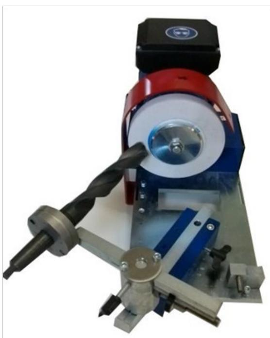
Slika 40 - Ponovno oštrenje pomoću dodatka za brušenje svrdla
