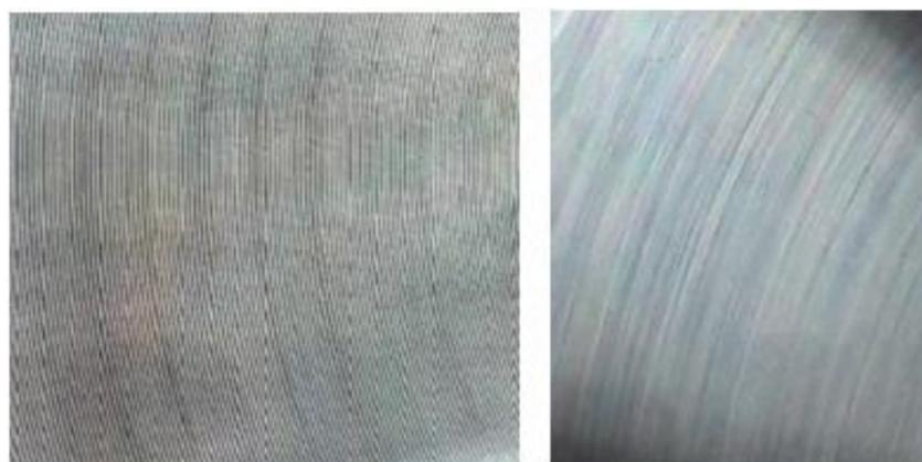
Slika 48. Izgled površine sa grubljom obradom (lijeko) i finijom obradom (desno)
