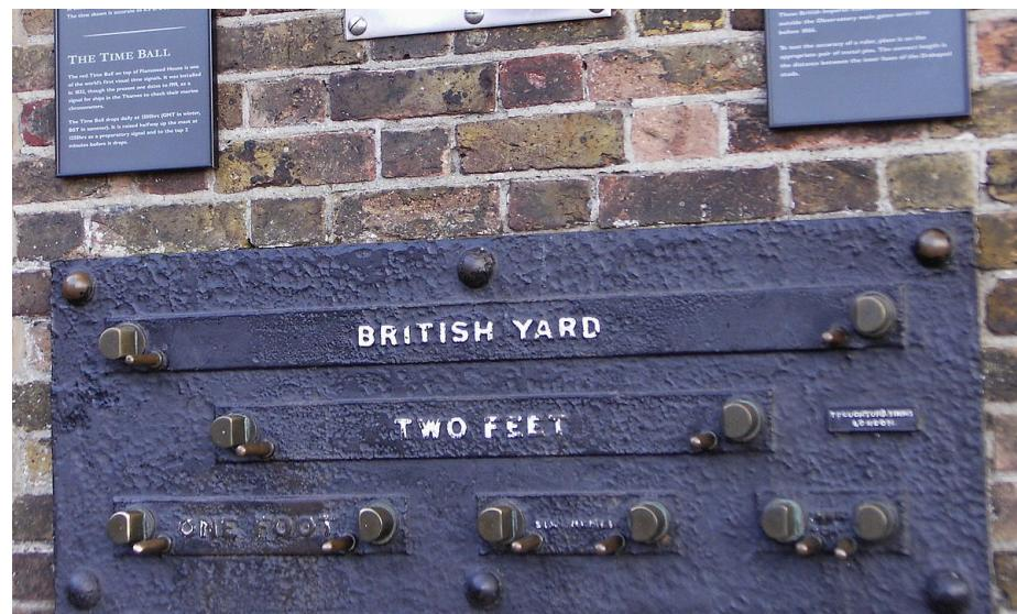
Slika 4 - Standardne dužine na zidu Kraljevskog opservatorija, Greenwich, London, osnova imperijalnog sistema mjera
