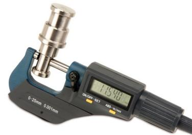
Slika 21 - Digitalni mikrometar
