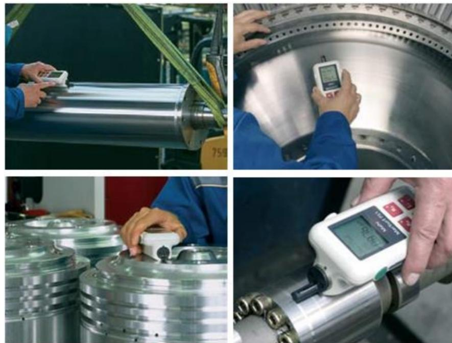
Slika 49. Različiti primjeri mjerenja hrapavosti površine pomoću uređaja sa ticalom
