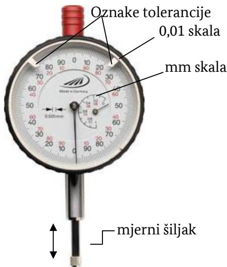
Kada se mjerni šiljak gurne prema gore, igla komparatora rotira i prikazuje rezultat očitanja.
