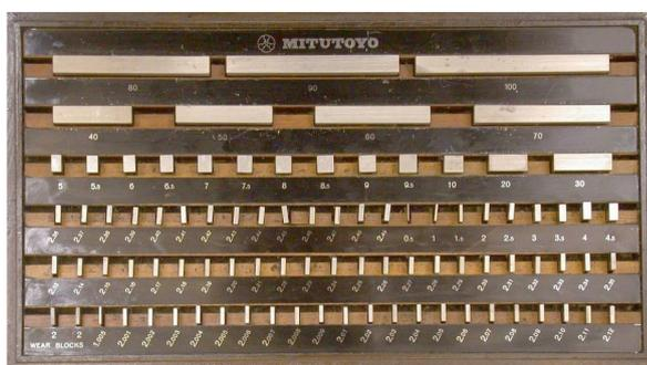
Slika 33 – Garnitura etalona za umjeravanje – mjerne pločice
