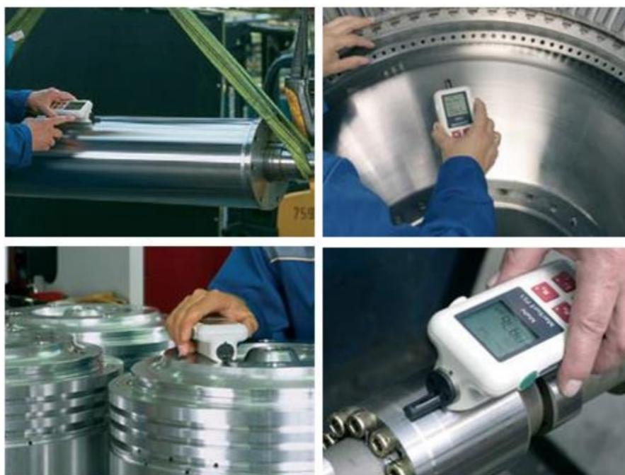
Slika 49 - Različiti primjeri mjerenja hrapavosti površine pomoću uređaja sa ticalom
